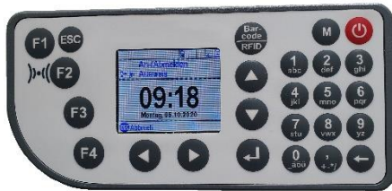
Mobiles Erfassungsgerät mit RFID-Leser und WLAN
